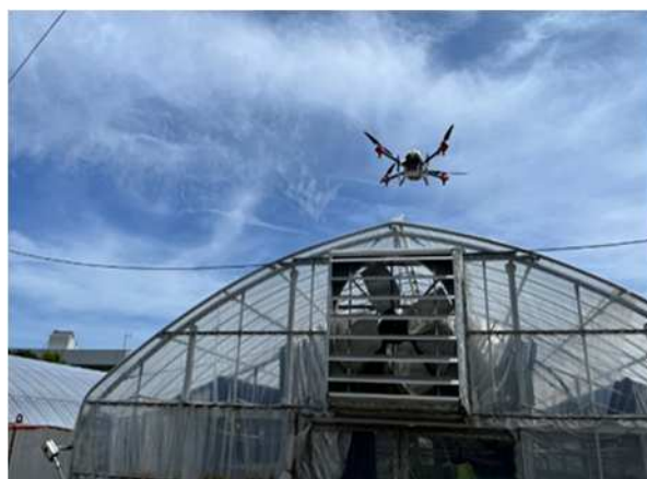
写真1 ドローンによる遮熱剤散布の様子
