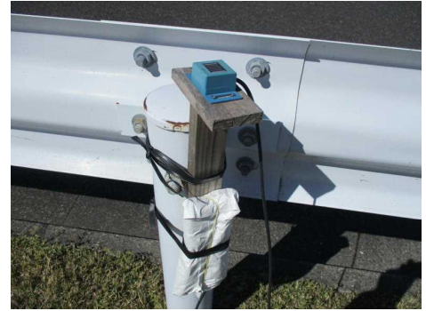
図1 日射計の設置状況
