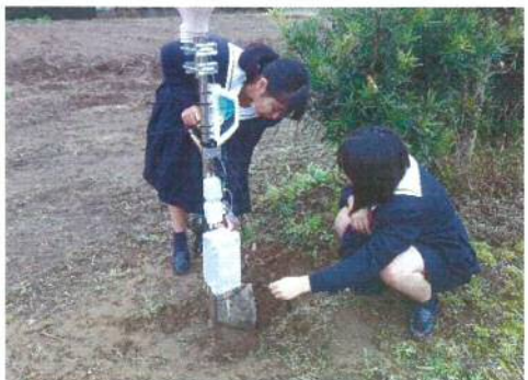
【写真3】Field Server の設置
