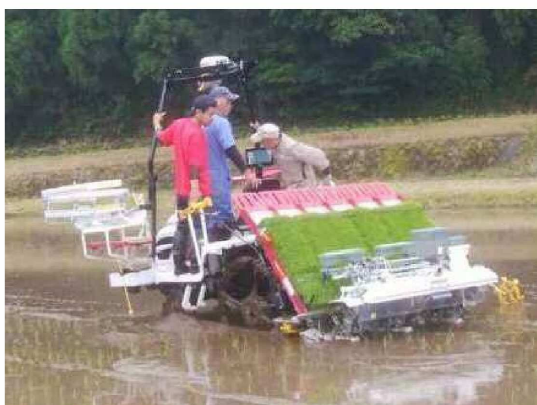
写真3 移植作業（自動操舵）
